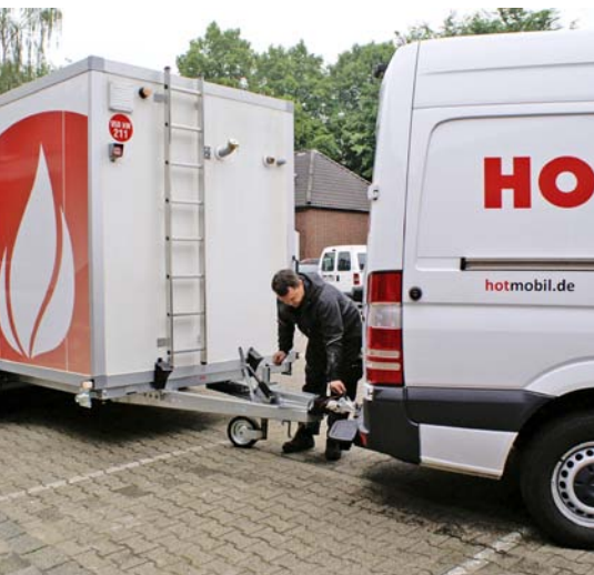
6 Mobile Heizzentrale, die in Kombination mit mobilen Lufterhitzern auch zur energieeffizienten Bauheizung eingesetzt wird.
